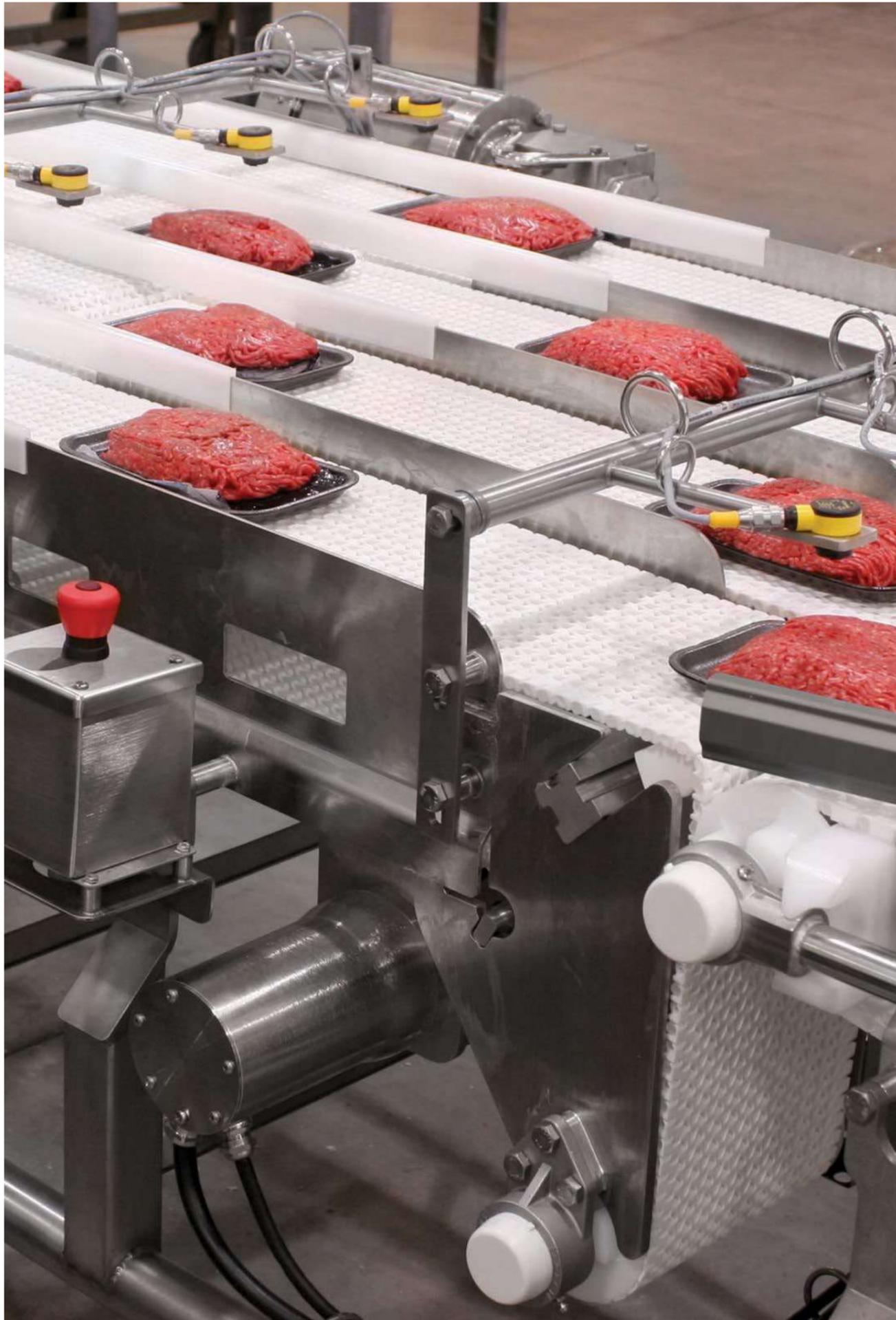
Die Kunststoffmodulketten-Förderbänder aus Edelstahl oder Aluminium können außer mit Geradeauslauf insbesondere auch für den Lauf mit ein oder mehreren Kurven ausgestattet werden. Bei Strecken mit Steigungen oder Gefällen bieten sich Testläufe an.
