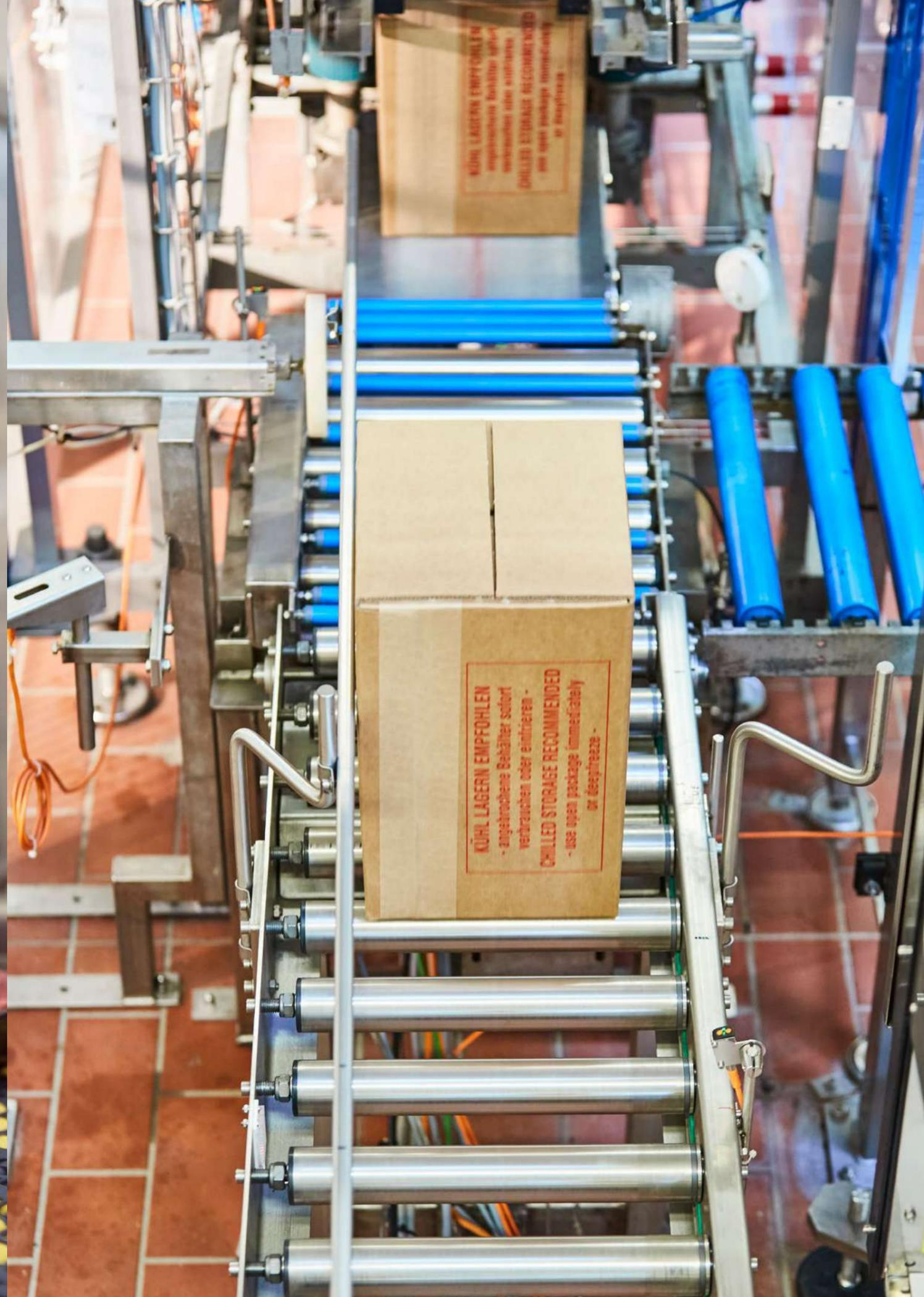
Die Bahnbreite ist das lichte Maß zwischen den Profilen bzw. Rahmen, somit ist die effektive Nutzbreite geringfügig kleiner als die Bahnbreite. In der Regel sollte die Bahnbreite etwas breiter als das Fördergut sein, das ist besonders bei Kurven mit Seitenführung wichtig, um den reibungslosen Durchlauf des Fördergutes sicher zu stellen.
