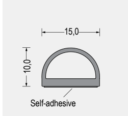
Part-Nr. 5940.4217 60° ShoreA · grau VE: Bund á 25m als Montagehilfe einseitig selbstklebend
