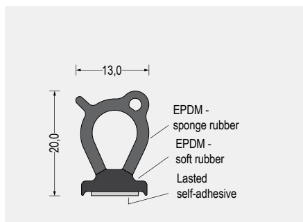
Part-Nr. 5600.0806 EPDM-Moos-/Weichgummi · schwarz VE: Bund á 50m mit Acrylic Foam-Selbstklebebeschichtung
