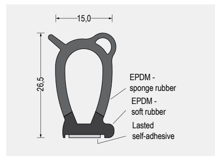
Part-Nr. 5600.0807 EPDM-Moos-/Weichgummi · schwarz VE: Bund á 50m mit Acrylic Foam-Selbstklebebeschichtung
