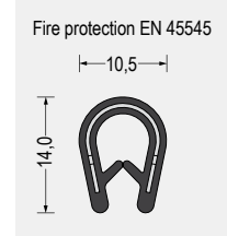
Part-Nr. 5610.8149 Weichgummi EPDM schwarz Brandschutzqualität EN 45545 Klemmbereich 2-4mm VE: Bund á 100m
